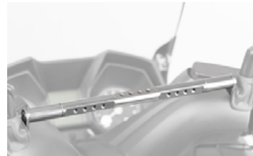
SUPPORT MULTIFONCTION Montage entre retroviseurs Entraxe réglable 354mm à 376mm Ref KA-01-0422 50€
