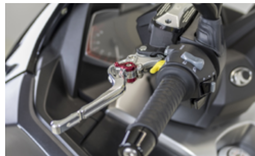
JEU DE LEVIERS ALUMINIUM RÉGLABLES 6 POSITIONS Leviers aluminium 6061 taillés dans la masse - Anodisés gris et traitement de dureté T60 - Réglables 6 positions Vendus par paire
