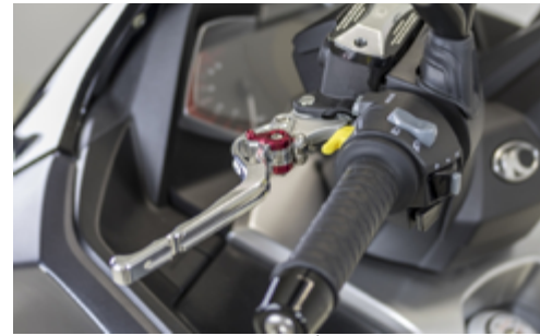
JEU DE LEVIERS ALUMINIUM RÉGLABLES 6 POSITIONS Leviers aluminium 6061 taillés dans la masse - Anodisés gris et traitement de dureté T60 - Réglables 6 positions Vendus par paire Ref KA-01-0454 120€
